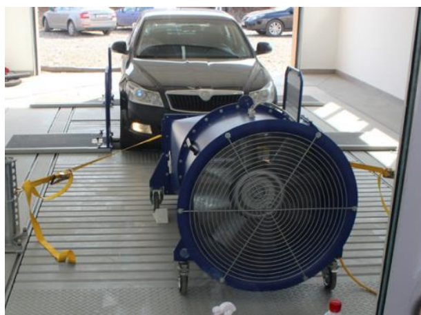
Slika 3: Ispitno vozilo na šasijskom dinamometru AVL Roadsim Chassis Dyno 48" 4WD MiM'
